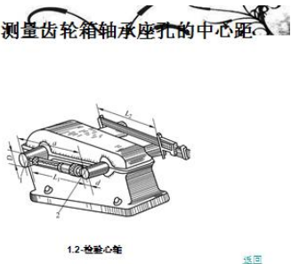
图6-4 检查齿轮轴线的平行度
