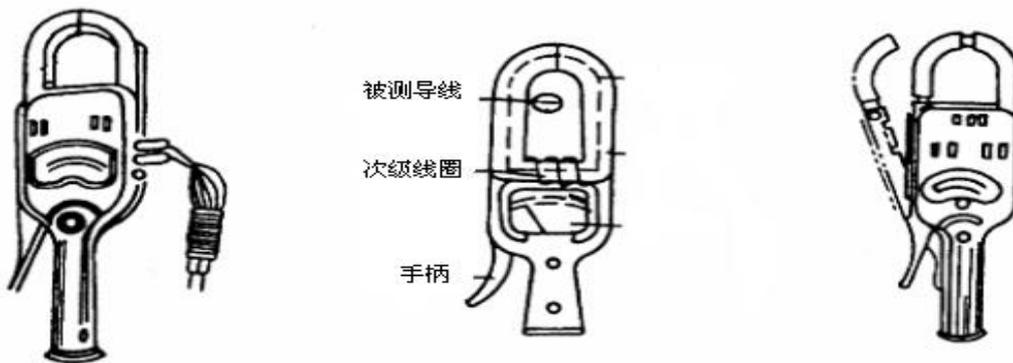
使用钳形表测量前，应先估计被测电流的大小以合理选择量程。使用钳形表时，被测载流导线应放在钳口内的中心位置，以减小误差；钳口的结合面应保持接触良好，若有明显噪声或表针振动厉害，可将钳口重新开合几次或转动手柄；在测量较大电流后，为减小剩磁对测量结果的影响，应立即测量较小电流，并把钳口开合数次；测量较小电流时，为使该数较准确，在条件允许的情况下，可将被测导线多绕几圈后再放进钳口进行测量（此时的实际电流值应为仪表的读数除以导线的圈数）。
